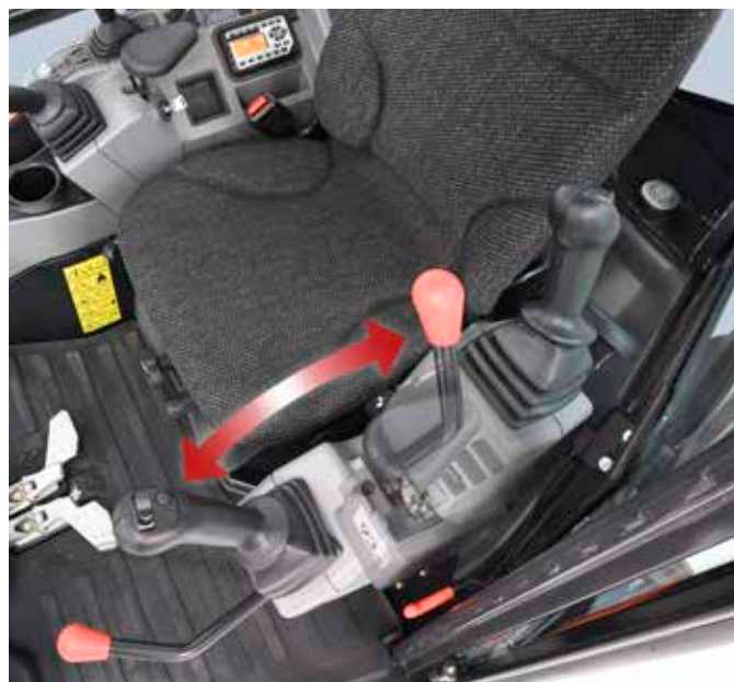
Funzione di inclinazione del supporto comandi
